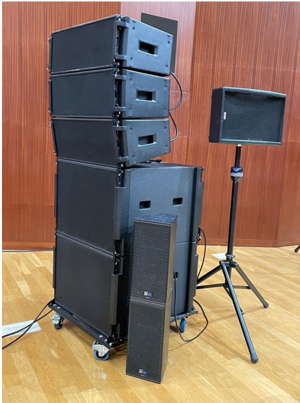
図 13 ハウスとインフィルとサイドフィル 3種類のスピーカー
