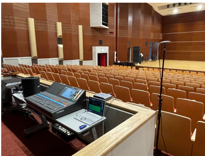
図6 FOH コンソールと、プロセッサーと音響測定兼用のPC
