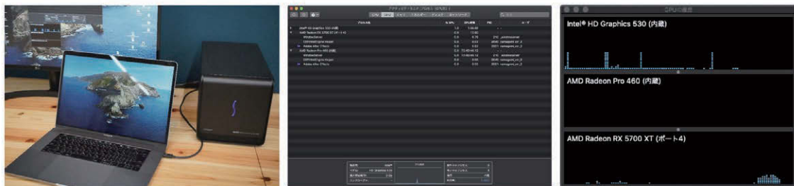
図 22. eGPU から Thunderbolt3 経由で PC へ給電可能。同時に GPU 処理を外部で行い、学生ノート PC を高速化。*
