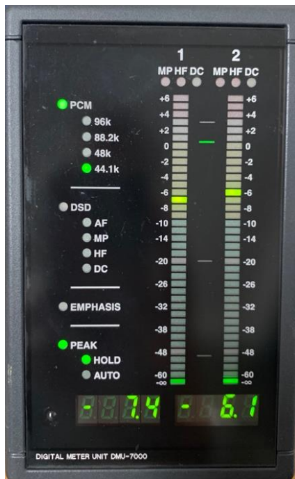
図11 1枚目の35DH-1をデジタルピークメータ「DMU-7000」で表示させたもの 今回は左チャンネルを解析対象にしているため、ピーク値は-7.4dBである
