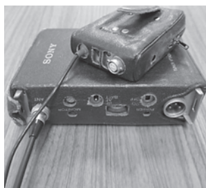
写真11. 465 [MHz] 帯のSONY WRT-27 (送信機) とWRR-27 (受信機)
