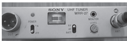
写真11. 465 [MHz] 帯のSONY WRT-27 (送信機) とWRR-27 (受信機)
