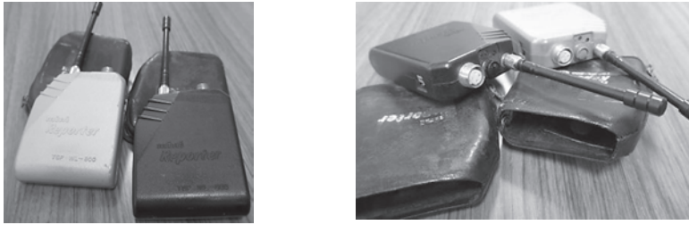
写真12. ENG用として1986年に作られた800 [MHz]帯の TSP ミニリポーター WL800
