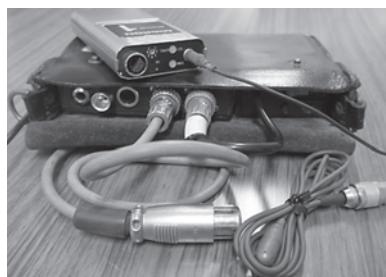
写真10. 465 [MHz] 帯のワイヤレスマイク AUDIO MICRON 102
