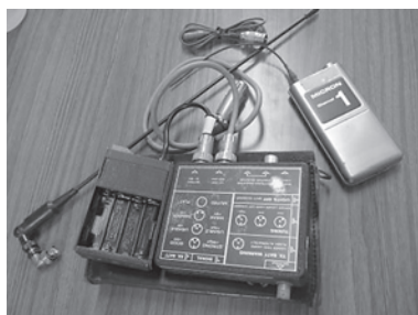
写真10. 465 [MHz] 帯のワイヤレスマイク AUDIO MICRON 102
