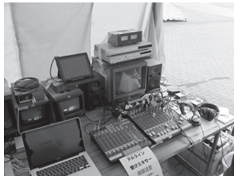
写真44. 映像系、音声系、配信系 (配信サーバ等) の3ブロックで設置。
