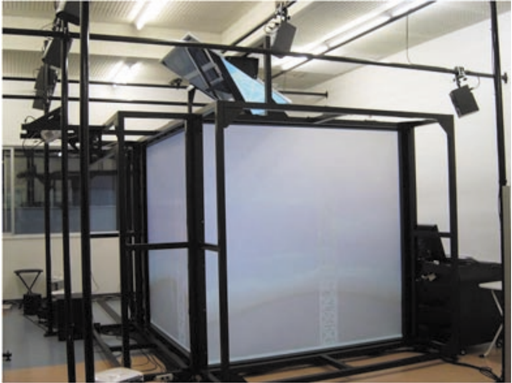
図2 テラリウムのマルチスクリーンと、14.1chスピーカ。上部にあるのは反射ミラー。
