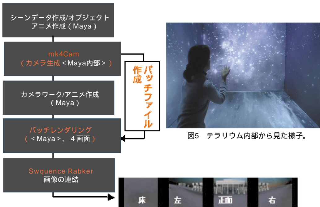
図4 制作の流れと連結した4画面分の画像。4096 x 786pix
